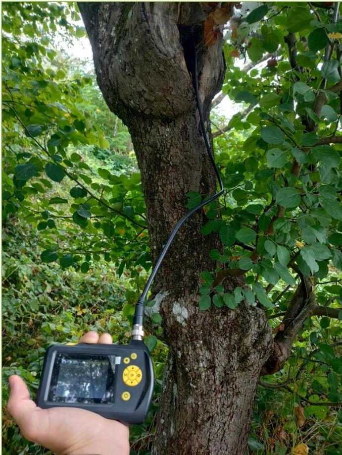
**Abbildung 5** Baumhöhlenkontrolle mittels Endoskopkamera.
